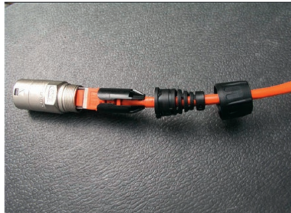
Abb. 11 So wird das Ethernet-Kabel in den Stecker eingeführt. Die Teile werden zusammengeschoben und mit der Überwurfmutter am Ende in das Metallteil gepresst.
